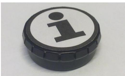
Abbildung 20: Gegenstand mit optischem Merkmal zur Aktivierung des Informationslayers (*tag*)
