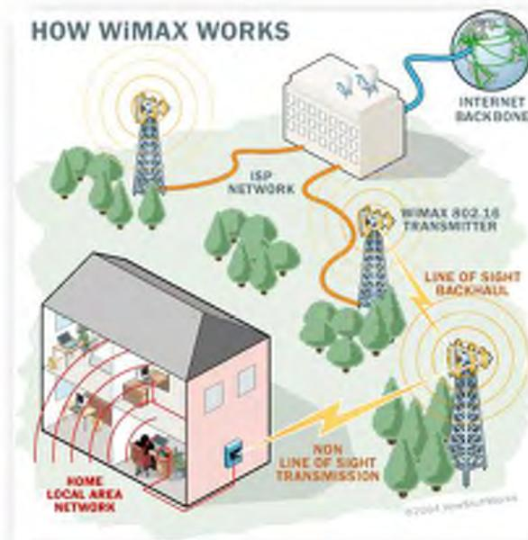
Abbildung 2.2: Aufbau eines WiMAX Netzwerks [17].
