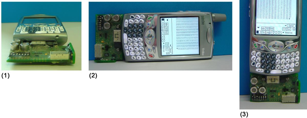
Abbildung 4.11.: Unterschiedliche Lagen des Sensor-Board zur Kalibrierung der Winkelbeschleunigungssensoren
